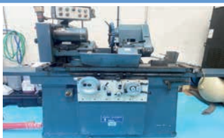
JONES & SHIPMAN 1302 EIT (12489) UNIVERSAL CYLINDRICAL GRINDER , Capacity 14" x 27": Hydraulic Feeds : Double Swivel : Swivel Wheelhead : Swivel Workhead : 3 Jaw Chuck : Internal Spindle : Steadies : Wheel Dressers : Low Volt Light : Coolant : Splash Guards. POA
